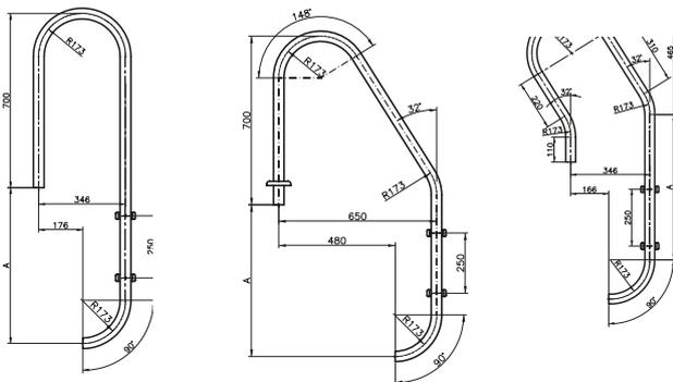
Aus V2A und V4A (salzelektrolysetauglich). Die Edelstahlstufen sind mit rutschfesten Auflagen. Inklusive Leitereinbauhülsen. Holm  $\varnothing$  43 mm.
